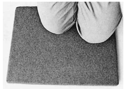
Fig. 3: le soudeur à l'arc se protège du courant électrique en utilisant un support isolant et des chaussures de sécurité.
