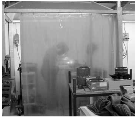
Fig. 8: pour les postes de travail voisins devant être protégés, il convient d'utiliser des écrans mobiles ou des rideaux amovibles ignifuges (les écrans transparents doivent respecter la norme SN EN 1598).
