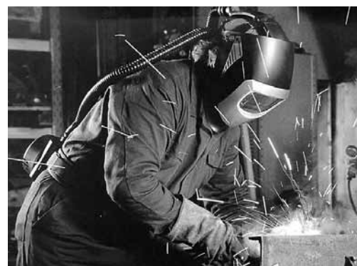
Fig. 5: aux postes de travail mal aérés, il faut utiliser un casque de soudeur avec système d'amenée d'air frais lors du soudage manuel à l'arc et du coupage plasma de pièces en alliage.
