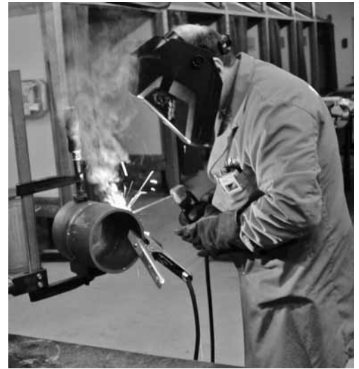
Fig. 1: avant de commencer à travailler, le soudeur doit s'assurer que le connecteur de retour de courant de soudage est branché correctement.
